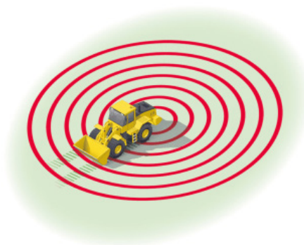
Het geluid verspreidt zich in iedere richting over een grote afstand met een tonal achteruitrijalarm.
