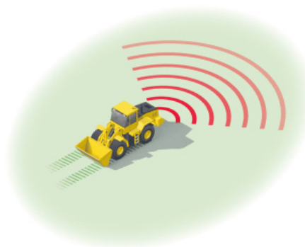
Eén van de eigenschappen van een multi frequentie achteruitrijalarm is dat het geluid maar in één richting verplaatst.
